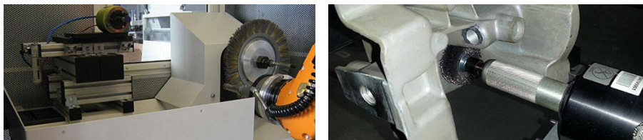
Figura 5 Sistema de desbarbado robotizado de SHL
