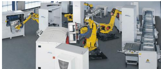
Figura 4 Celda de pulido automatizada de SHL
