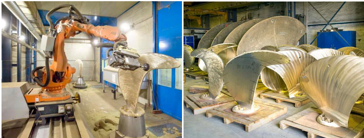
Figura 9 Ejemplo de mecanizado robotizado (rectificado y pulido) de componentes navales en una planta de producción del grupo Wärtsilä
