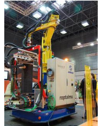
Figura 8 Robot taladrador Roptalmu TECNALIA
