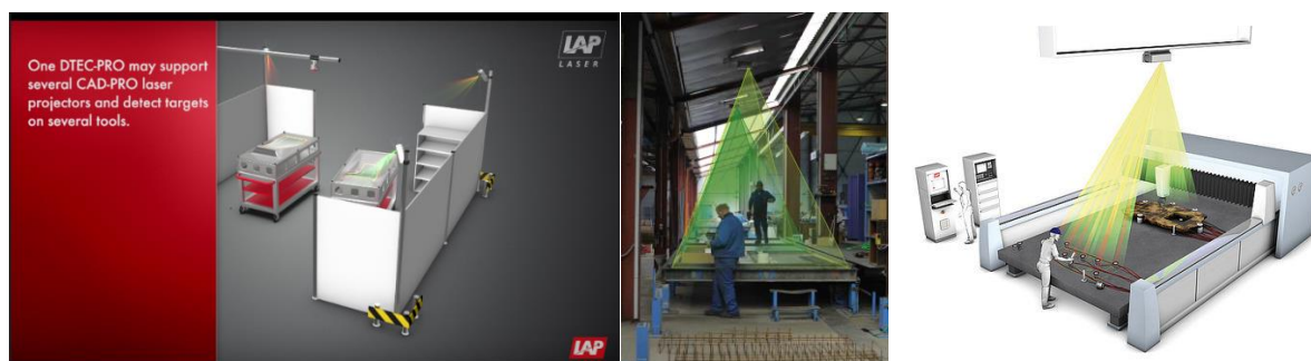
Figura 2 Solução Lap Laser para projeção de informação na industria metalomecânica e metalúrgica.
