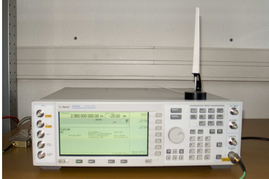
FIG. 4.6 – L'émetteur : Générateur de signaux Agilent.
